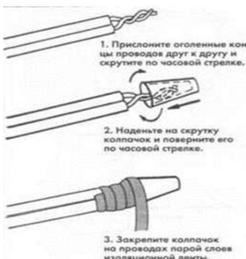
Рисунок 2 – Соединение жил кабеля
