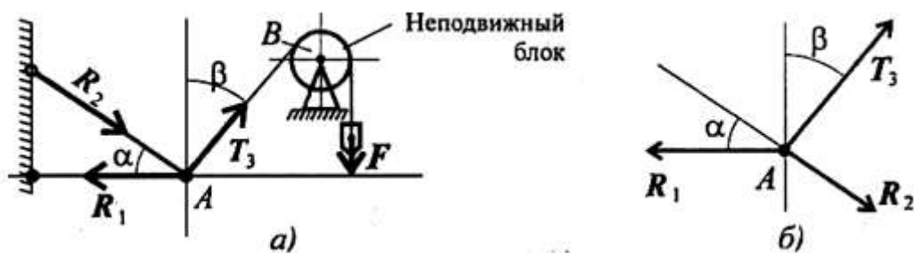
а) Силы, действующие на шарнир А. б) Система сходящихся сил.
