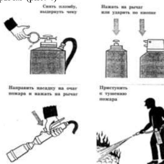
Рис.1. Приведение в действие воздушно-пенного огнетушителя.
