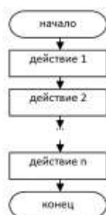
Рис.1 Блок-схем для реализации линейного алгоритма
