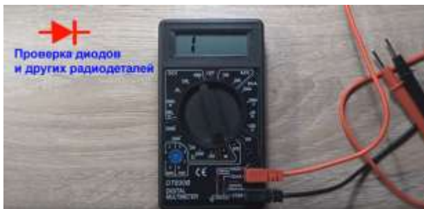
Рисунок 28 – Мультиметр для проверки диодов
