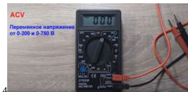
Рисунок 12 - Измерение переменного напряжения
