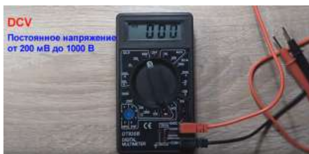
Рисунок 13 - Измерение постоянного напряжения
