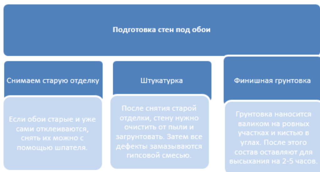
Рисунок 1 – Подготовка стен под обои
