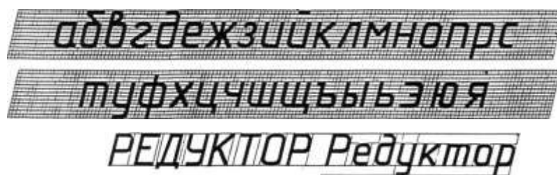
Рис.3 Буквы чертежного шрифта
