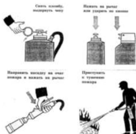
Рис.1. Приведение в действие воздушно-пенного огнетушителя.
