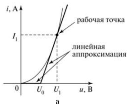
Рис. 1. Линейная аппроксимация прямой ветви ВАХ диода (а) и схема замещения диода (б)
