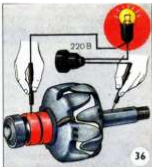
Рисунок 11 Проверка обмотки возбуждения на замыкание с корпусом
