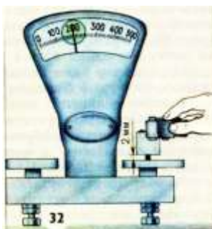
Рисунок 8. Проверка пружин щеток генератора на весах
