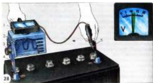
Рисунок 5 Измерение напряжения аккумуляторной батареи под нагрузкой пробником Э107
