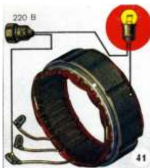
Рисунок 16 Проверка обмотки статора на замыкание с корпусом
