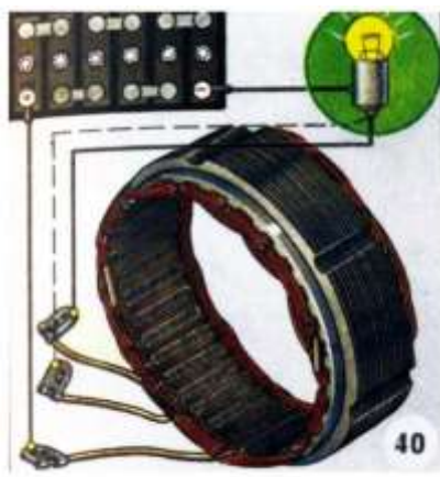
Рисунок 15 Проверка обмотки статора на обрыв
