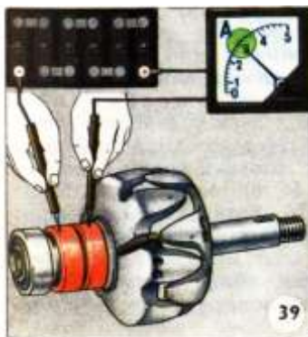
Рисунок 14 Измерение силы тока в цепи обмотки возбуждения
