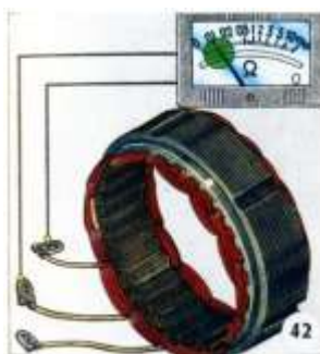
Рисунок 17 Измерение сопротивления фаз обмотки статора омметром
