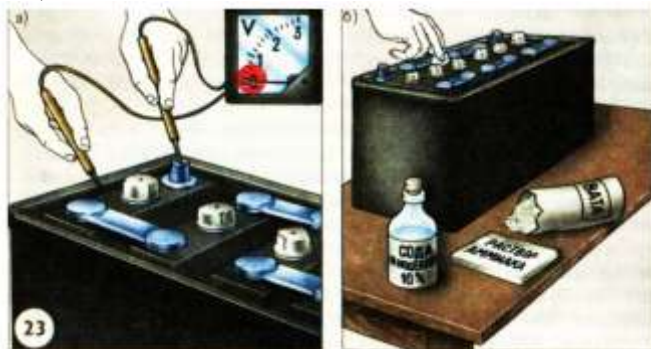
Рисунок 1 Определение (а) и устранение (б) утечки тока на мастике
