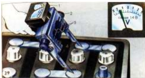
Рисунок 6 Измерение напряжения аккумулятора под нагрузкой пробником Э108
