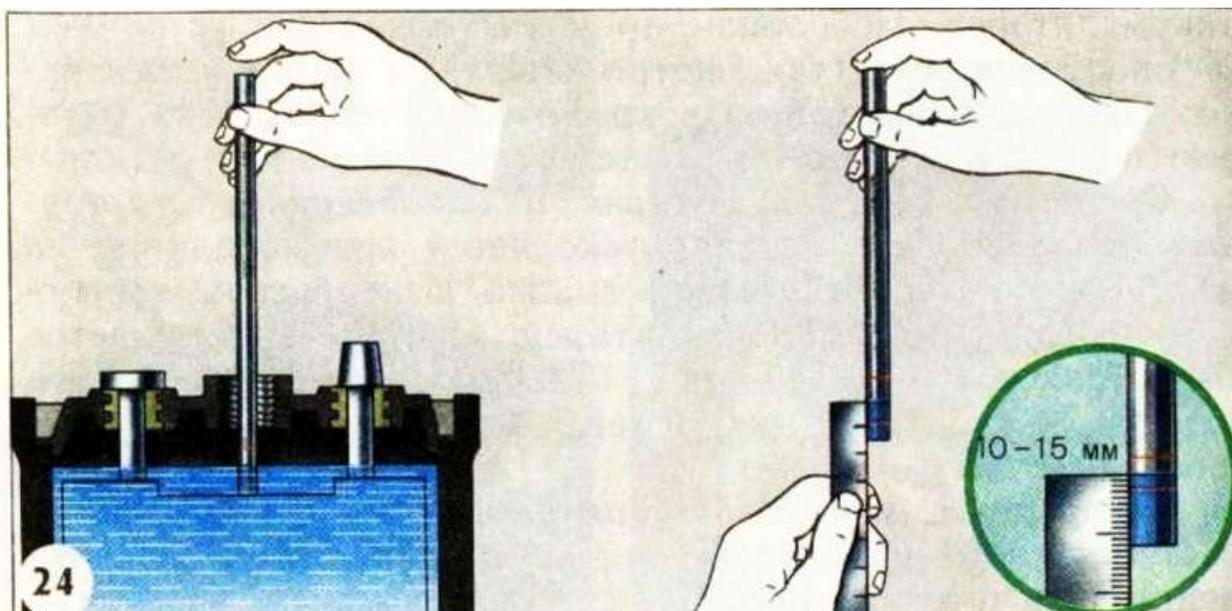
Рисунок 2 Измерение уровня электролита
