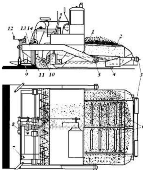
1 - шиберные заслонки; 2 - бункер; 3 - буферные ролики; 4 - гусеничный ход; 5 - шаровой шарнир; 6 - пластинчатые питатели; 7 - горелка; 8 - винты регулирования профиля; 9 - выглаживающая плита; 10 - распределяющие шнеки; 11 - трамбующий брус; 12 - винты регулировки толщины слоя; 13 - брусья; 14 - эксцентриковый механизм трамбующего бруса
