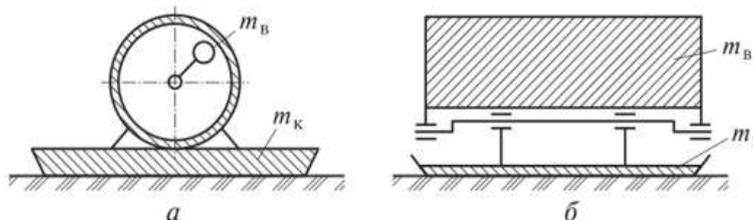
Рис. 6.9. Принципиальные схемы вибротрамбующих машин с центробежным (а) и колебаний
