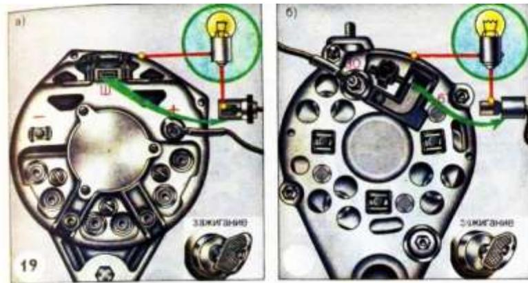
Рисунок 5 Проверка цепи возбуждения генератора на обрыв: а — Г 250; б — Г221
