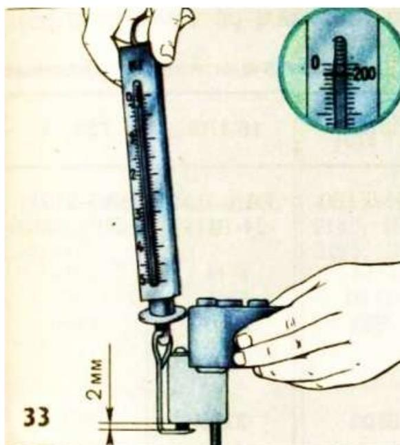
Рисунок 9. Проверка пружины щеток с помощью динамометра
