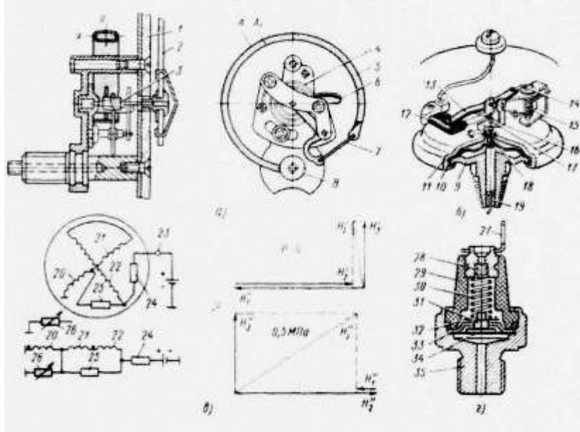
Рисунок 2. Указатель давления: а) механизм указателя с трубчатой пружиной;
