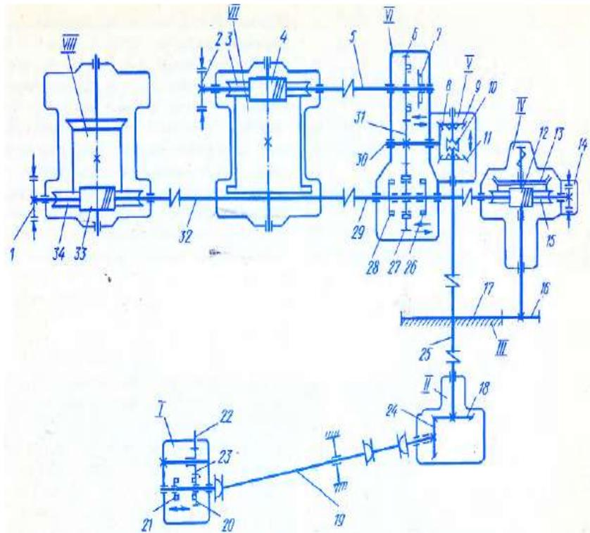
Рис. 58. Кинематическая схема кранов КС-2561Д:
