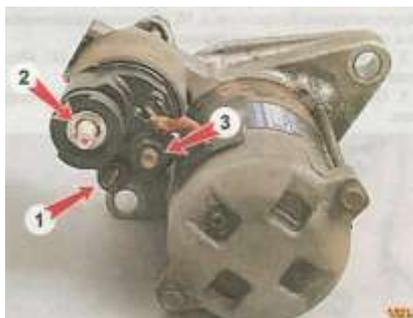
4.2. Подсоединяем второй провод к контактному болту 2 тягового реле. Используя отвертку или другой подходящий металлический предмет, замыкаем между собой вывод 1 и контактный болт тягового реле. Если раздастся громкий щелчок и якорь стартера начал вращаться, тяговое реле исправно.
