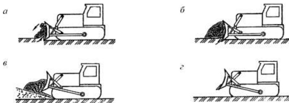
а - резание; б - транспортирование с подрезанием; в - отсыпка; г - возврат назад (холостой ход)
