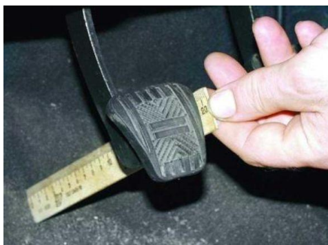
Рисунок 1- Проверка свободного хода педали сцепления
