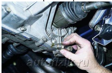
Рис. 2. проверка уровня масла в коробке передач
