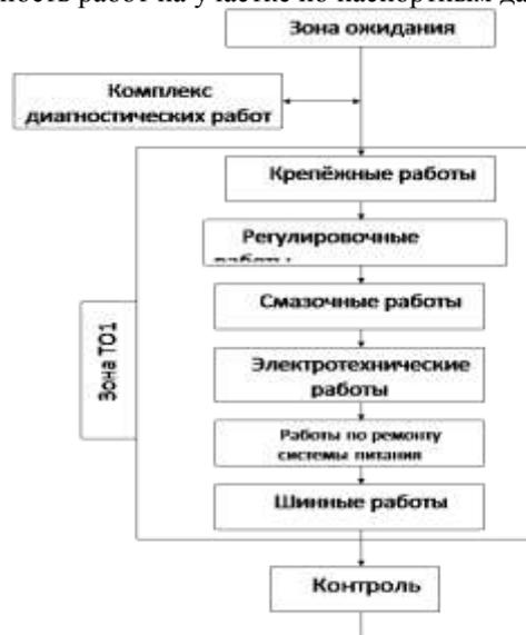
Рисунок - Схема организации технологического процесса зоны ТО-1
