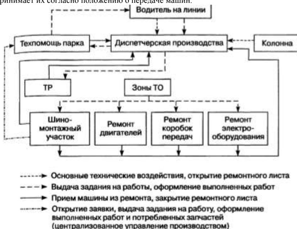
Рисунок 1.1-Организация и управление производством ТО и ремонта подвижного состава
