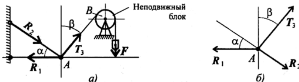
Рисунок 1 – Груз, подвешенный на стержнях и канатах а) Силы, действующие на шарнир А. б) Система сходящихся сил.
