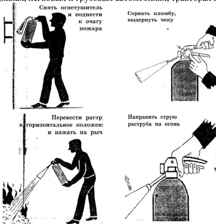
Рис. 3. Приведение в действие ручного углекислого огнетушителя.
