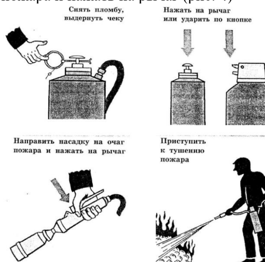
Рис.1. Приведение в действие воздушно-пенного огнетушителя
