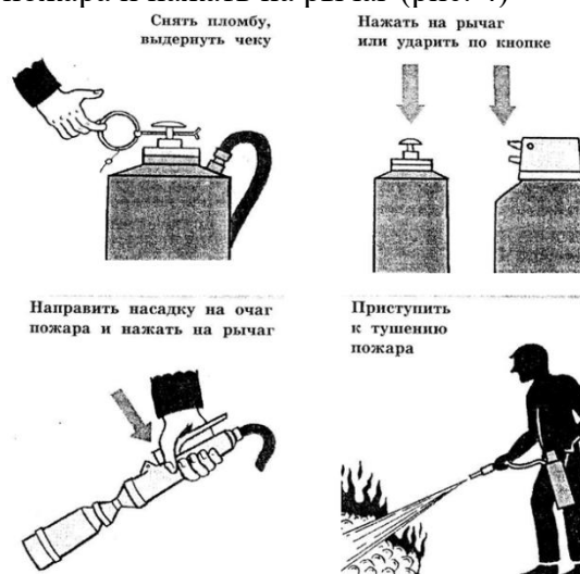
Рис.1. Приведение в действие воздушно-пенного огнетушителя
