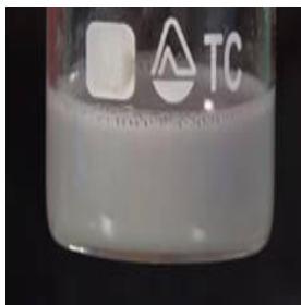
Рис. 3. Разложение пероксида водорода под действием катализатора \text{MnO}_2
