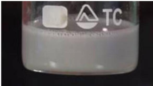
Рис. 3. Разложение пероксида водорода под действием катализатора  $MnO_2$
