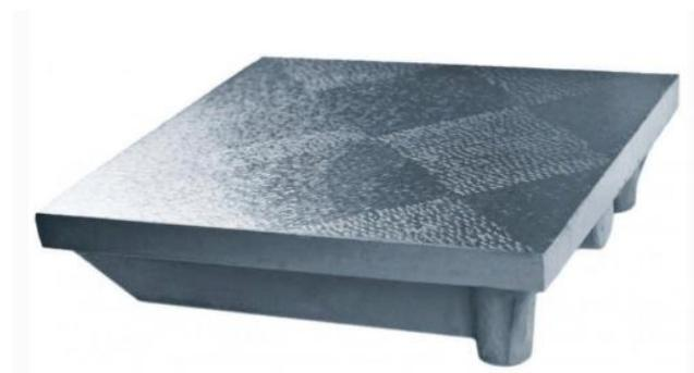
*Рисунок 6 – Плита разметочная*
