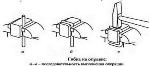
Плоскогубцы и круглогубцы применяют при гибке профильного проката толщиной менее 0,5 мм и проволоки. Плоскогубцы предназначены для захвата и удержания заготовок в процессе гибки. Они имеют прорезь около шарнира. Наличие прорези позволяет производить откусывание проволоки. Круглогубцы также обеспечивают захват и удержание заготовки в процессе гибки и, кроме того, позволяют производить гибку проволоки.
