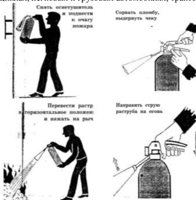
Рис. 3. Приведение в действие ручного углекислого огнетушителя.
