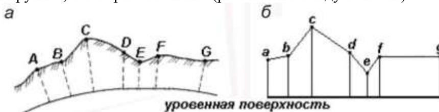
Рисунок 3.2. Вертикальный разрез (а) и профиль (б) местности
