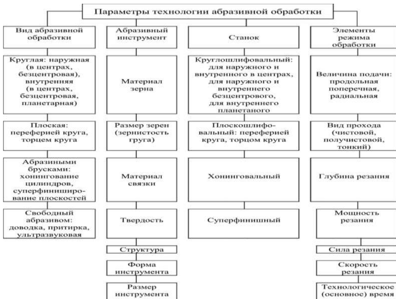
Рис.1. Схема параметров технологии абразивной обработки
