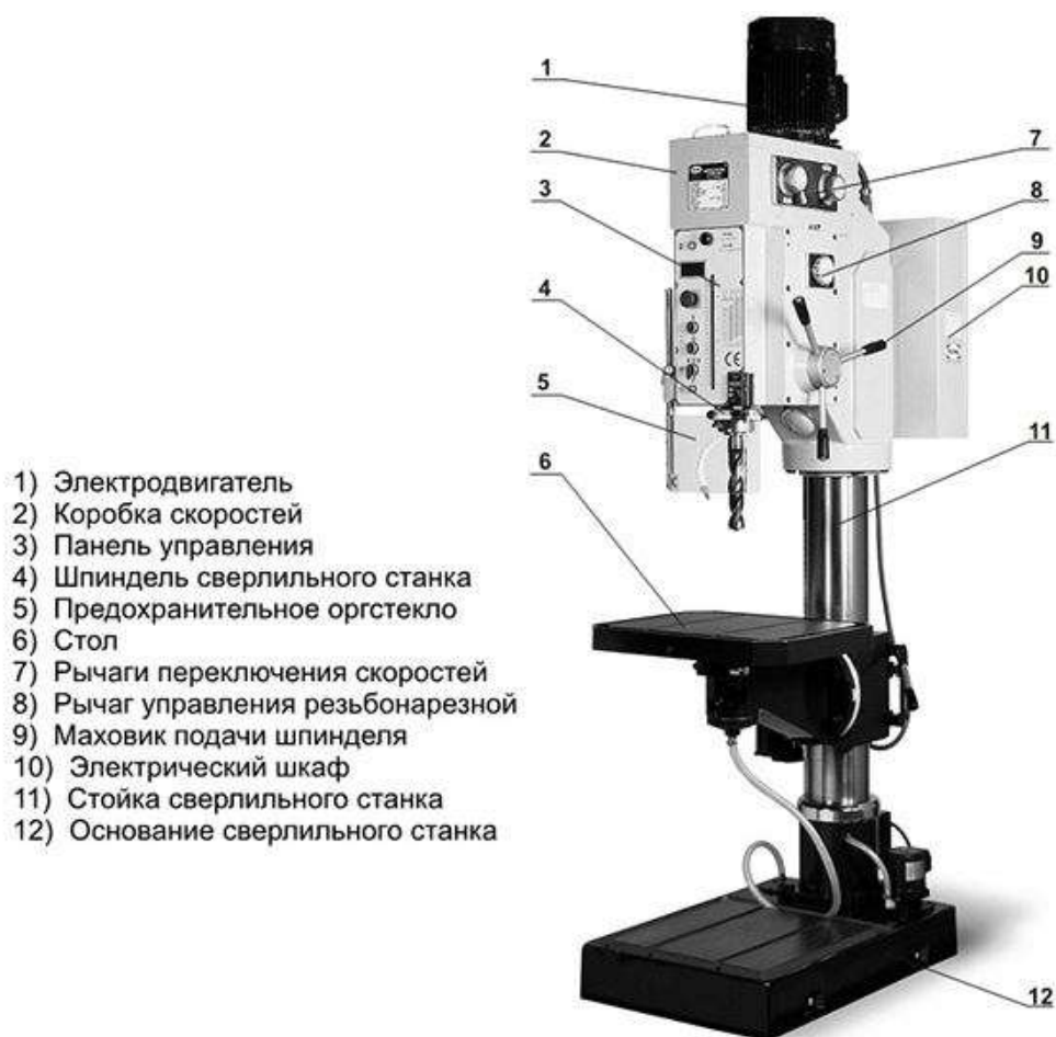
Основные узлы сверлильного станка
