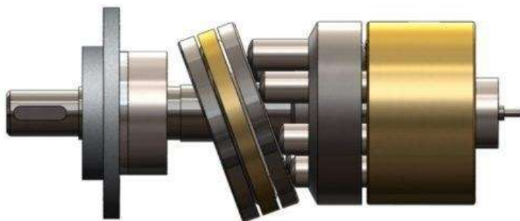
Аксиально-поршневой с наклонным диском (шайбой)
