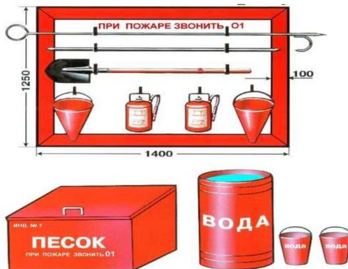
Рисунок 6 - Пожарный щит первичных средств пожаротушения
