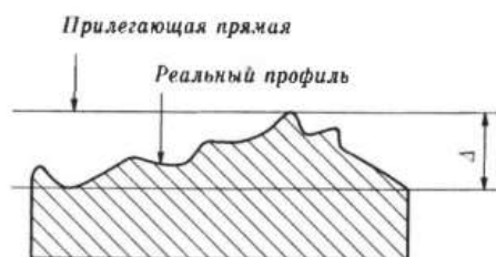
Рис. 4.1 Прилегающая прямая и реальный профиль
