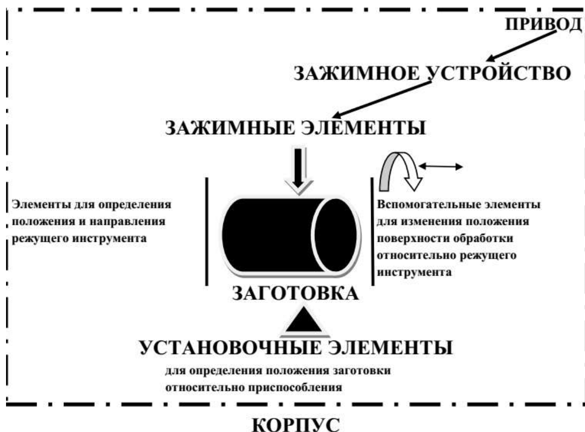
Рис. 1. Структура станочного приспособления
