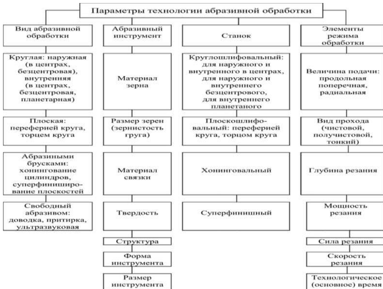
Рис.1. Схема параметров технологии абразивной обработки
