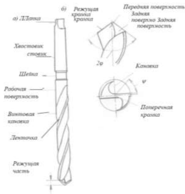
Рис.1. Части и элементы спирального сверла
