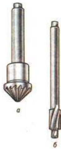
Рис. 1. Зенковки: а - коническая; б - цилиндрическая.
