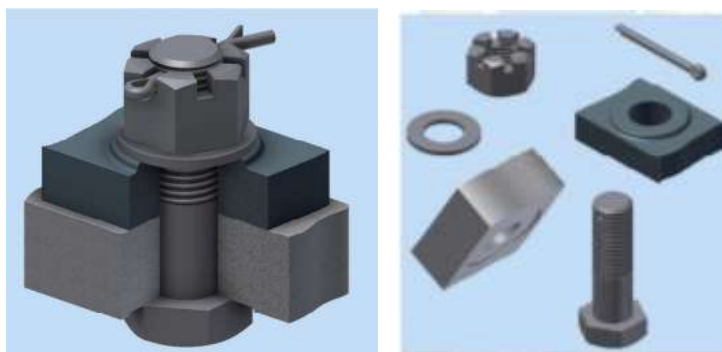
Рис.8- Соединение болтовое: а- в сборе, б- детали
