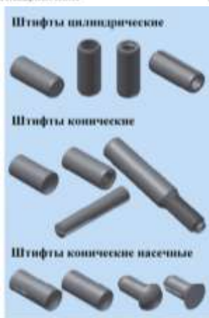
Рис. 7. Конструкция стандартных штифтов
