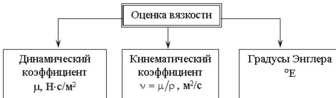
Рисунок 4 – Способы оценки вязкости жидкости
