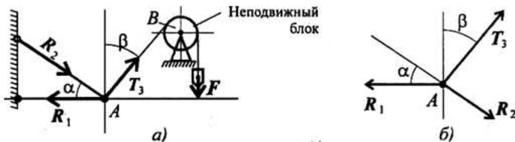
а) Силы, действующие на шарнир A .
