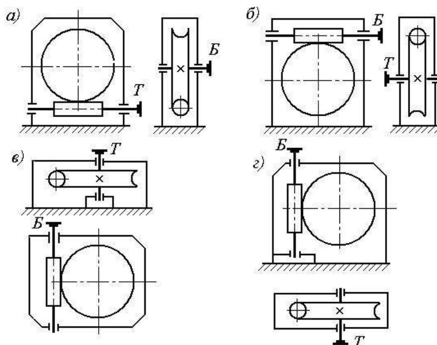
Рисунок 3 - Схемы червячных редукторов:
