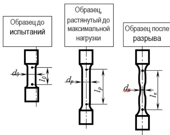
Рисунок 1 - Схема цилиндрического образца на различных стадиях растяжения
