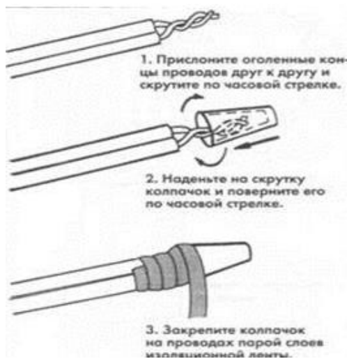
Рисунок 2 – Соединение жил кабеля
