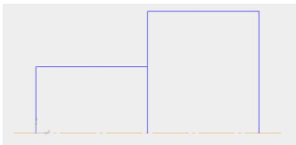
в) Перестроить фаску в угловых точках пересечения трех отрезков 1 и 2, 3 и 4, 4 и 5. Для этого на панели Геометрия выбрать инструмент Фаска
