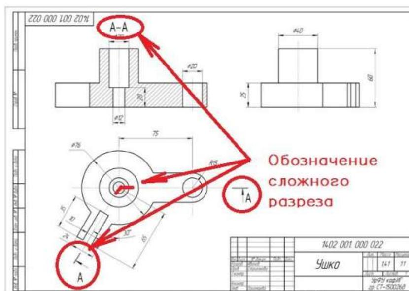
Рис 29 Обозначение сложного ломаного разреза на чертеже
