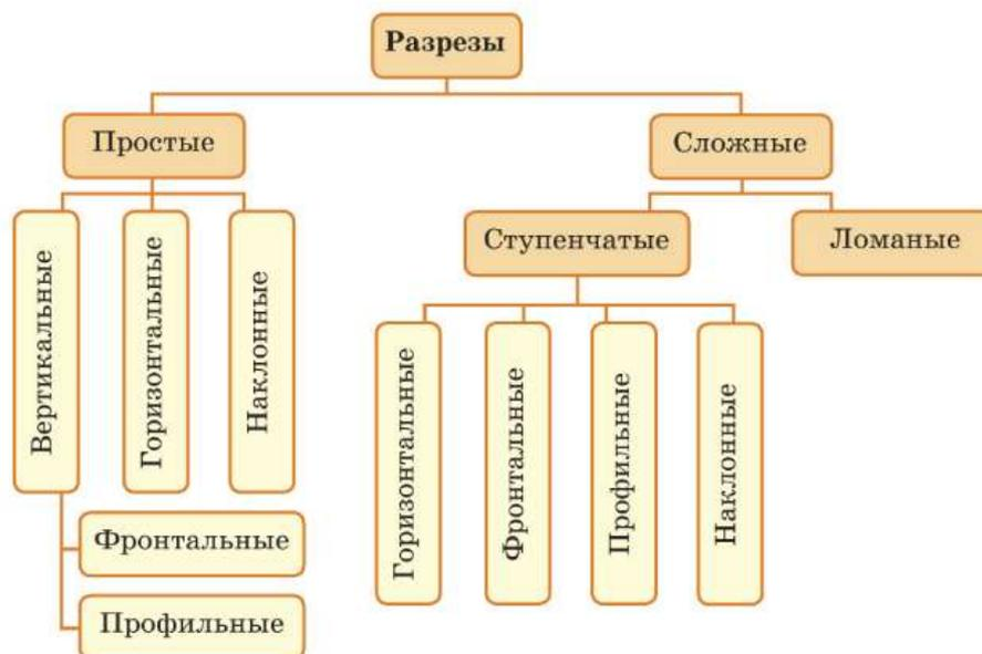
Рис 25 Классификация разрезов
