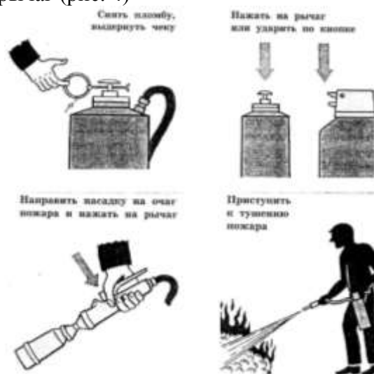
Рис.1. Приведение в действие воздушно-пенного огнетушителя.
