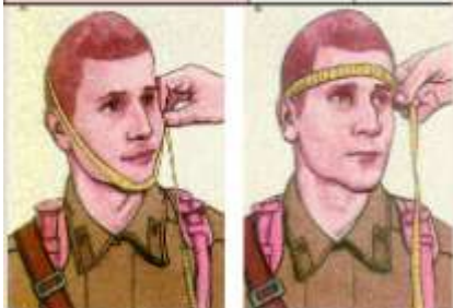
Рис.1. Подбор противогаза по размеру.
