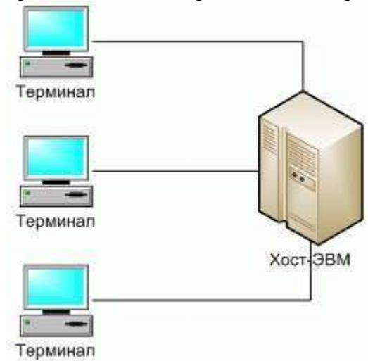
Рис. 1. Классическое представление централизованной архитектуры Центральная ЭВМ должна иметь большую память и высокую производительность, чтобы обеспечивать комфортную работу большого числа пользователей.
