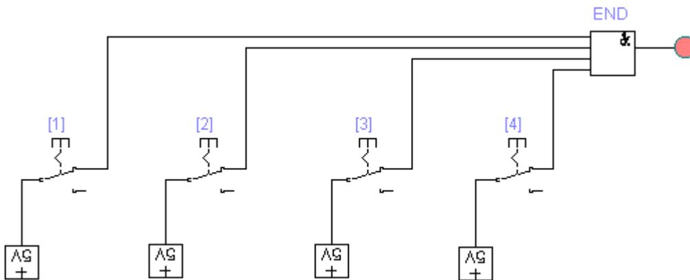
На выходе логической схемы "И" появляется логическая 1 (горит светодиод) только при подаче логических 1 (потенциал 5 вольт) на все четыре входа логической схемы "И".
