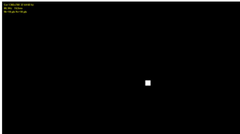
Тест для визуальной оценки быстродействия матрицы. Параметры для сравнения – яркость движущегося квадрата, длина «хвоста», размытость границы, цвет и геометрия квадрата.
