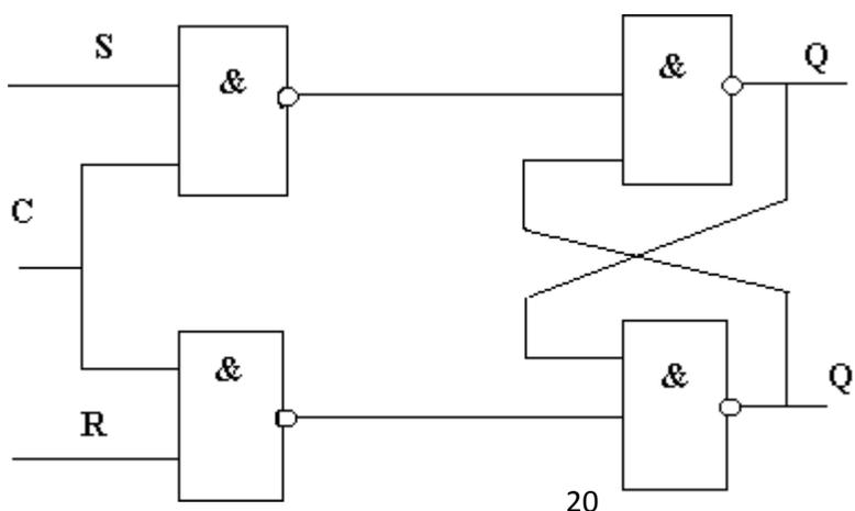
Рис. Синхронный R-S триггер на логических элементах "И-НЕ" Пример построения модели схемы синхронного R-S триггера.
