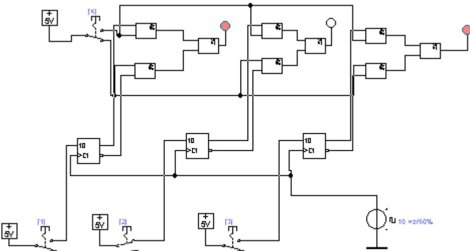
При изменении положения переключателя К на индикаторах отображается инверсный код. Составить временную диаграмму работы регистра параллельного занесения.
