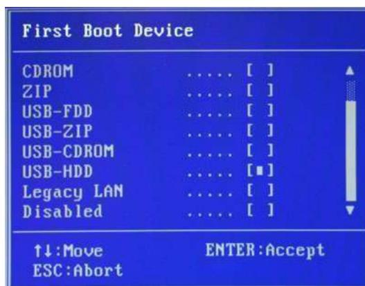
Далее перед вами откроется окно со списком устройств, которые можно выбрать в качестве загрузочных. Если планируется запуск ПК с оптического диска, то выбираем при помощи стрелок значение CDROM и далее как обычно «Ввод». Если необходимо загрузиться с флэшки или внешнего портативного диска, то выбираем опцию USB-HDD. Таким же образом можно выбрать второе и третье загрузочные устройства (Second Boot Device и Third Boot Device).
