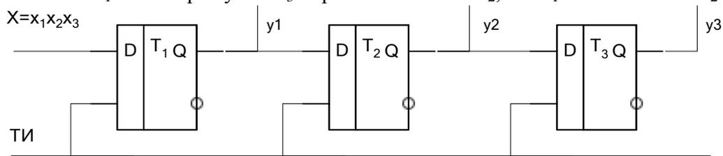
Таким образом, после трёх тактирующих импульсов всё число окажется записанным в регистр и может быть считано в параллельном коде с выходов  $Q_1, Q_2, Q_3$  ( $Y=X$ ) или  $!Q_1, !Q_2, !Q_3$  ( $Y=!X$ ). Процесс считывания организуется точно также, как и в схеме рис. 1
