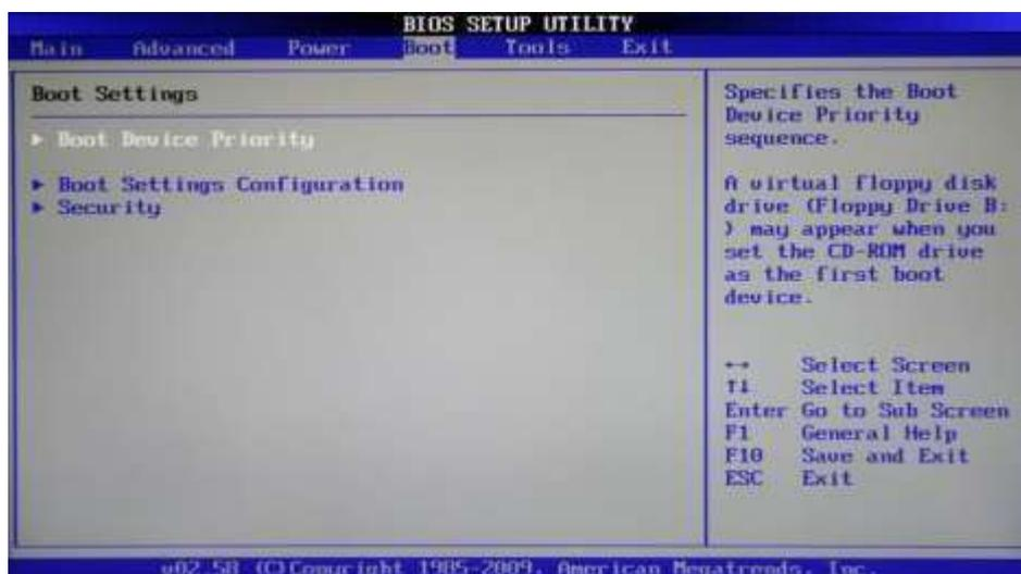
Во многих случаях раздел *Boot* включает в себя подраздел *Security*, содержащий команды установки, снятия или изменения административного и пользовательского паролей. В некоторых же версиях BIOS Setup параметры управления паролями могут быть вынесены в отдельный одноименный раздел.
