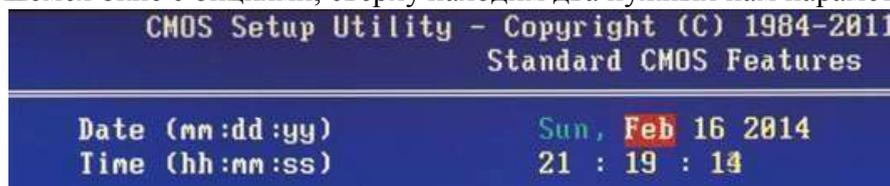
и Time (Время). Для перемещения между значениями параметров используйте стрелочки. Для установки значений можно применять как клавиши «+»/«PgUp» или «-»/«PgDn», так и непосредственный ввод цифр с клавиатуры. Для фиксации установленных значений предназначена клавиша «Ввод» («Enter»).
