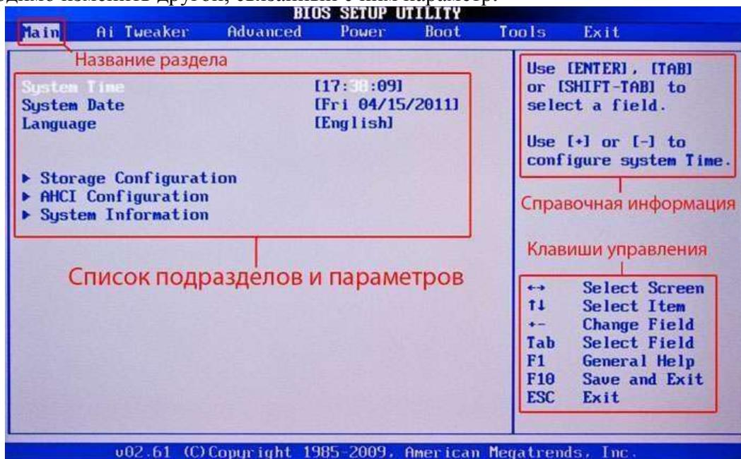
Правую часть экрана обычно занимает столбец, в котором выводится краткая справочная информация по выделенному параметру или подразделу, а так же подсказки по возможным действиям и использованию клавиш управления (American Megatrends). В программе настройки BIOS с синим фоном, подсказка по использованию функциональных клавиш располагается обычно в нижней части экрана.
