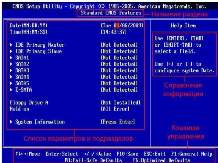
Основную часть экрана занимает область, в которой размещается список подразделов (обозначаются треугольными стрелками) и параметров выбранного раздела. Справа от наименования параметров располагаются их значения. При этом стоит учесть, что если параметр выделен бледным цветом (голубым или светло-серым), то он либо имеет статус «только для чтения» и несет исключительно информационный характер, либо для его редактирования необходимо изменить другой, связанный с ним параметр.
