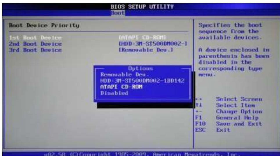
В первом случае вы увидите сразу список назначения загрузочных устройств. Обозначаются они как 1st, 2nd и 3rd Boot Devices (соответственно первое, второе и третье загрузочные устройства). Перемещение по списку производится клавишами «↑↓», выбор значений (HDD, CDROM, USB, Removable) – клавишами «Ввод» или «+/-».
