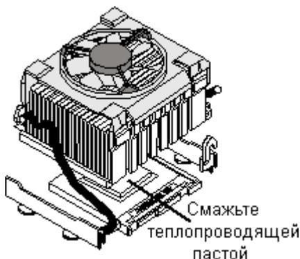
3. Опустите оба рычага, чтобы прижать вентилятор к процессору.
