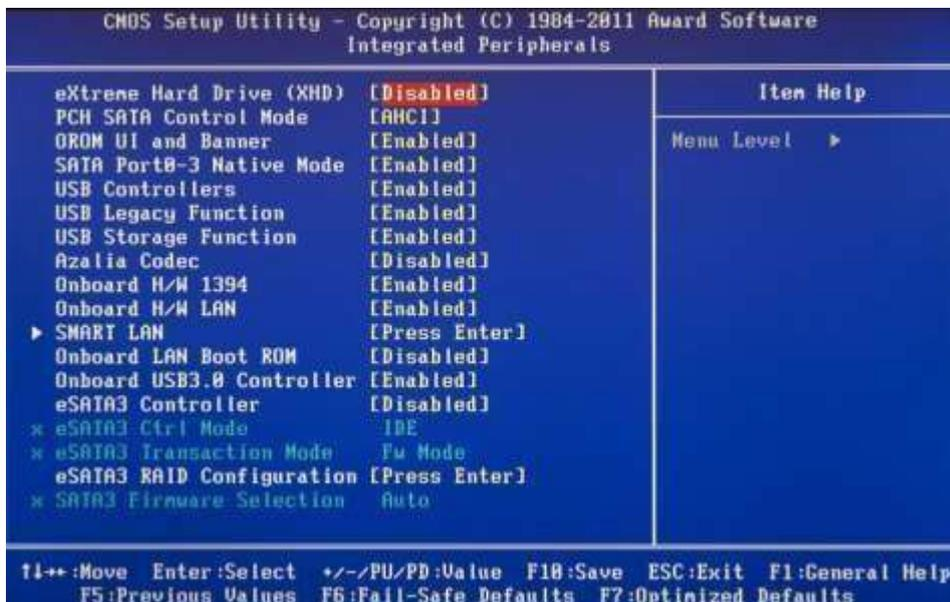
Например, здесь вы можете включить/отключить встроенную звуковую карту, поддержку USB-устройств ввода или выбрать режим RAID для создания массива жестких дисков.
