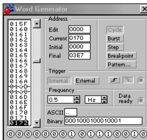
На рисунке генератор слова показан в развёрнутом виде. Генератор (или кодовый генератор) предназначен для генерации 16-ти разрядных двоичных слов, которые набираются пользователем на экране, расположенном в левой части лицевой панели. Для набора двоичных комбинаций необходимо щёлкнуть мышью на соответствующем разряде и затем ввести с клавиатуры число в десятичном коде.
