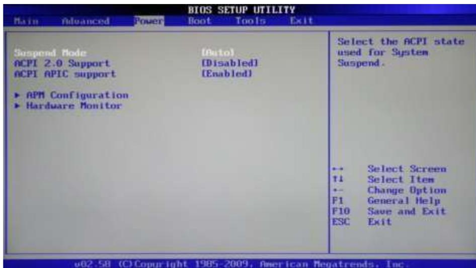
Здесь находятся параметры, отвечающие за электропитание и энергосбережение ПК, мониторинг рабочих температур и напряжений его основных компонентов, а так же контроля скоростей вращения вентиляторов.
