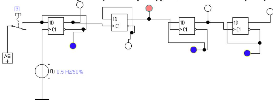
Пятивольтовый источник напряжения подсоединяется через переключатель к входу D1 триггера младшего (левого) разряда счетчика.
