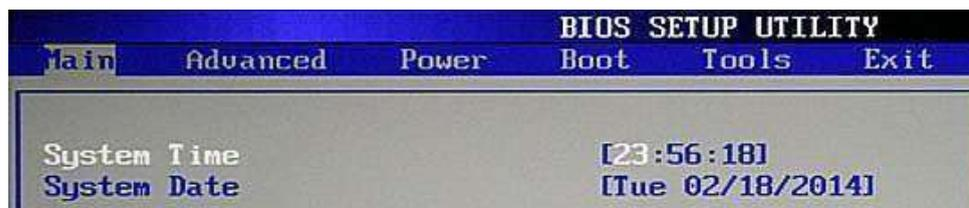
Находим в этом разделе параметры System Date (Системная дата) и System Time (Системное время) и перемещаем туда курсор, используя клавиши «↓» и «↑». Далее для ввода значений используем либо непосредственно клавиши с цифрами, либо клавиши «+» и «-». Для перемещения между полями внутри одного параметра здесь предназначена клавиша «Tab». После ввода требуемого значения нажимаем «Ввод».
