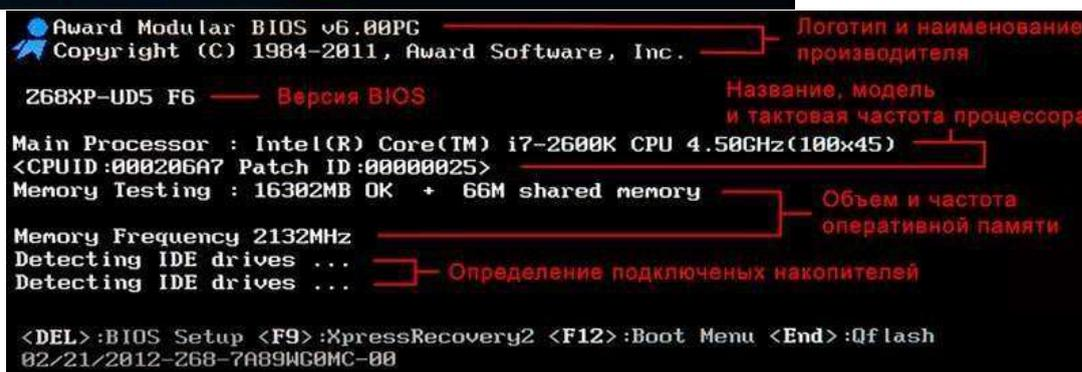
6. Затем запускается тестирование центрального процессора, по окончании которого на дисплей выводятся данные об установленном чипе: название производителя, модели и его тактовая частота.
