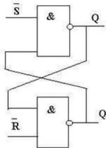
Рис. Асинхронный триггер на логических элементах И-НЕ
