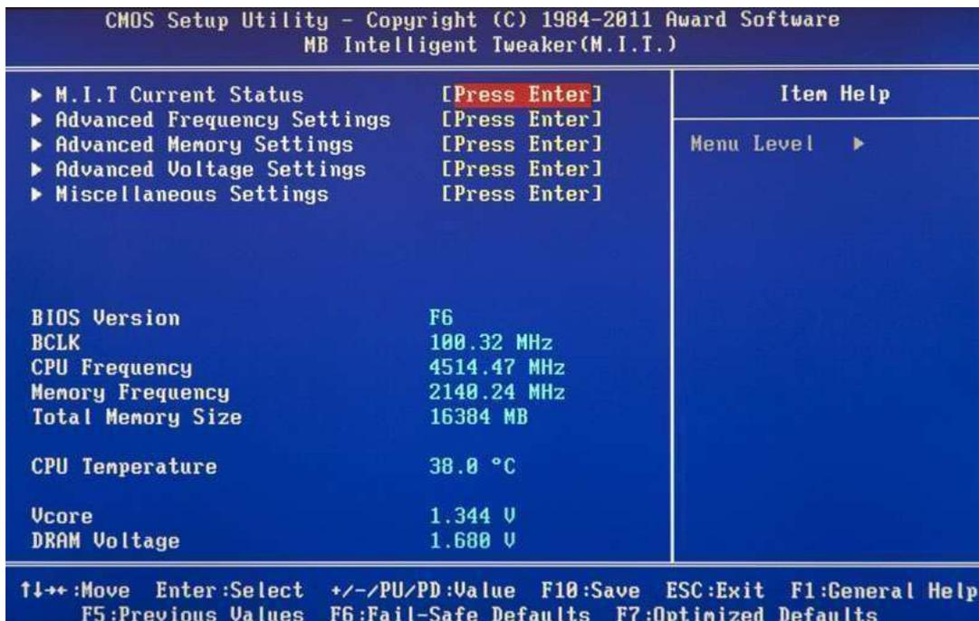
Стоит отметить, что многие крупные производители материнских плат опции по настройке частот и напряжений выносят в специальный раздел с оригинальным названием, например **MB Intelligent Tweaker (M.I.T.)** или **Cell Menu**.
