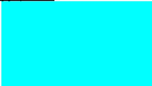
Тест равномерности подсветки матрицы и отсутствия «битых точек». Была произведена заливка следующими цветами: белый, красный, зеленый, синий, голубой, розовый, желтый, черный. По всему экрану цвет распределен равномерно, искажений не наблюдается. Тест показал, что дисплей не поврежден и «битых точек» нет.
