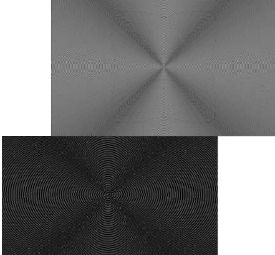
Тест концентрических окружностей. Он предназначен проверки интерполяции «неродных» разрешений. Перед проведением теста выполнили настройку монитора для каждого видеорежима. Тест выполнялся на \_\_\_\_\_ при «родном» разрешении \_\_\_\_\_, а также при «неродных» разрешениях: 1280x720, 1280x600, 800x600. Результаты тестов показали, что при «родном» разрешении окружности ровные, а при «неродных» выявляют искажения изображения, возникают пересечения линий.
