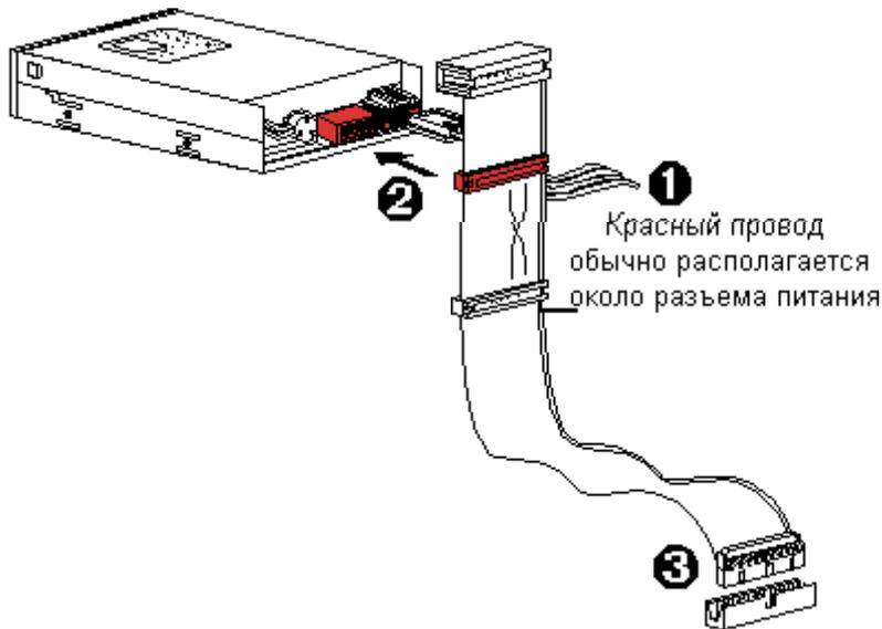
Не предусмотрено конструктивных решений, предотвращающих неверное подключение сигнального кабеля флоппи дисководов. Если флоппи дисковод после сборки не будет работать, а светодиод дисководов будет при этом постоянно светиться, проверьте сигнальный кабель.
