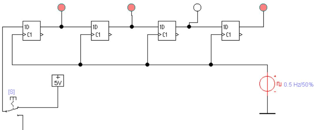
Изменяя частоту генератора синхроимпульсов в пределах 0.1 до 1 Гц, с помощью переключателя S (клавиша S) можно заносить последовательный код.
