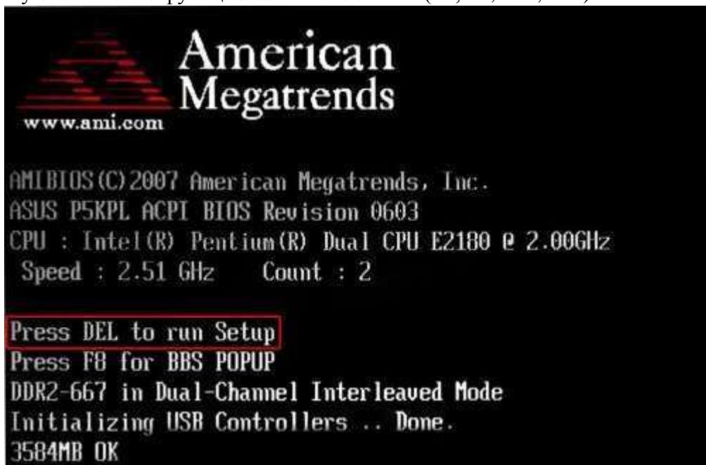
Узнать точно, какие из клавиш используются для запуска BIOS Setup можно из инструкции к компьютеру или системной плате. Так же в некоторых случаях во время прохождения процедуры POST на экран монитора выводится подсказка, о том какую клавишу необходимо нажать для входа в настройки.
