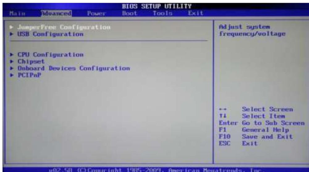
Так же в этом разделе можно найти опции разгона, позволяющие вручную задавать значения частот и напряжений процессора, памяти, а так же шины PCI-E. В некоторых случаях, дополнительно пользователям доступна регулировка задержек ОЗУ (тайминги/латентность). Во многих моделях материнских плат, параметры, отвечающие за разгон, выносятся в отдельный подраздел (например, *JumperFree Configuration*) или даже самостоятельный раздел главного меню (*AITweaker*, *Overclocking* или *ExtremeTweaker*).
