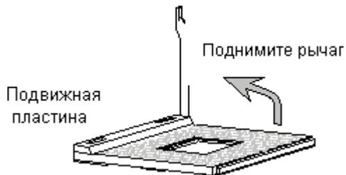
2. Обратите внимание на скошенный угол на процессоре. Он указывает на основание рычага. Процессор войдет в разъем только при правильном его расположении.
