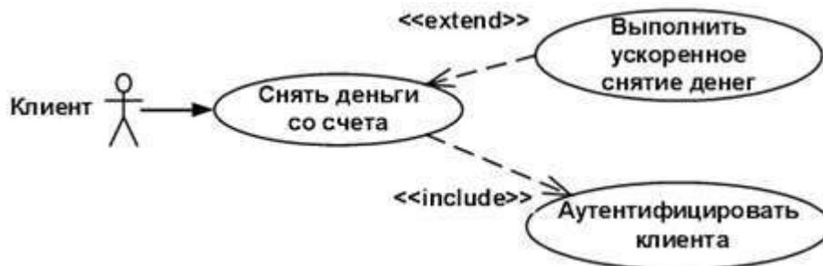
Рисунок 4 – Пример связи включения и расширения
