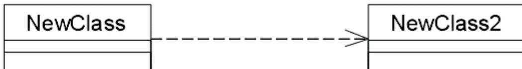
Рисунок 3 – Связь зависимость
