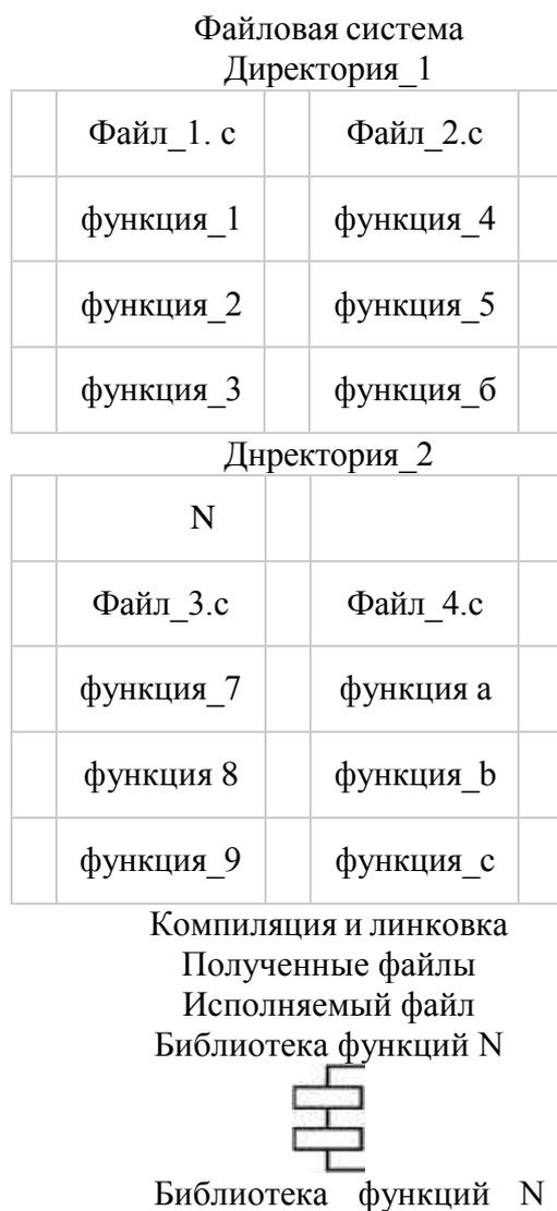
Рисунок 4 – Обычная сборка
