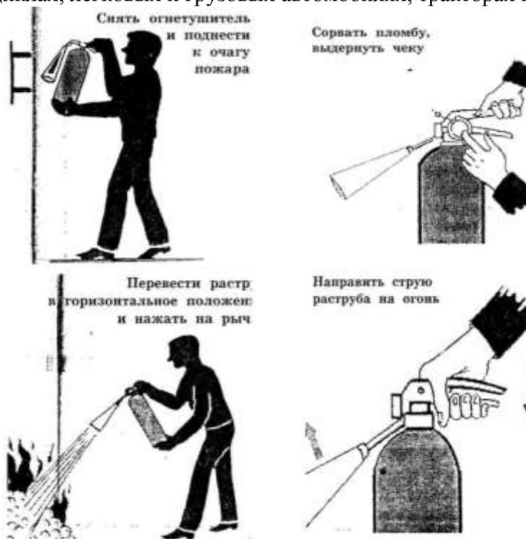
Рис. 3. Приведение в действие ручного углекислого огнетушителя.
