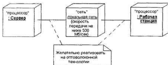
Рис. 3. Фрагмент диаграммы развертывания с соединениями между узлами
