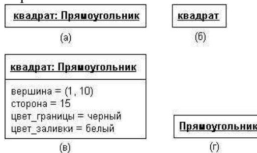
Рис. 11. Пример графического изображения объектов на диаграммах языка UML
