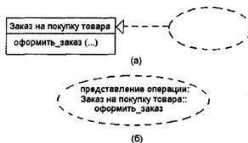
Рис. 3. Способы представления кооперации, которая реализует операцию класса
