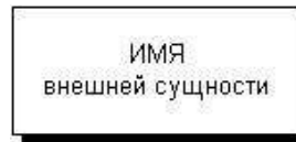
Рис. 1 Изображение внешней сущности на диаграмме потоков данных
