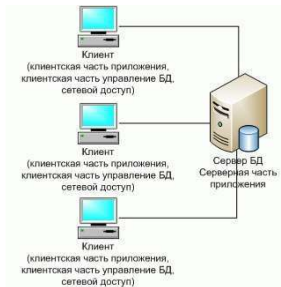
Рис. 3. Классическое представление архитектуры "клиент-сервер"
