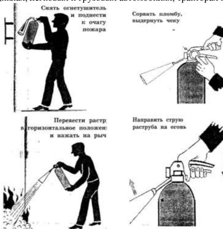
Рис. 3. Приведение в действие ручного углекислого огнетушителя.
