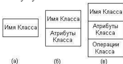
Рис.1. Графическое изображение класса на диаграмме классов
