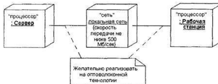
Рис. 3. Фрагмент диаграммы развертывания с соединениями между узлами
