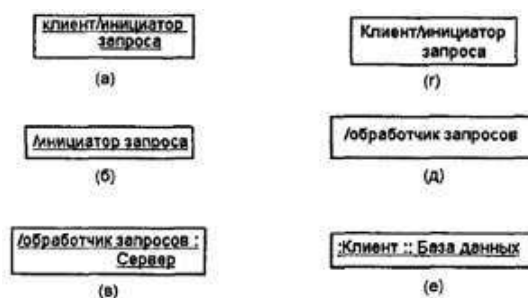
Рис. 4. Примеры различных вариантов записи имен объектов, ролей и классов на диаграммах кооперации
