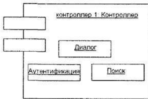
Рис. 8. Графическое изображение компонента уровня экземпляра, реализующего отдельные объекты
