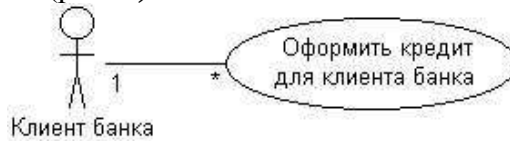
Рис. 4. Пример графического представления отношения ассоциации между актером и вариантом использования
