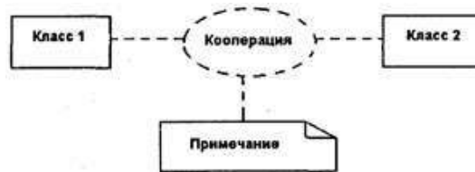
Рис. 1. Общее представление кооперации на диаграммах уровня спецификации
