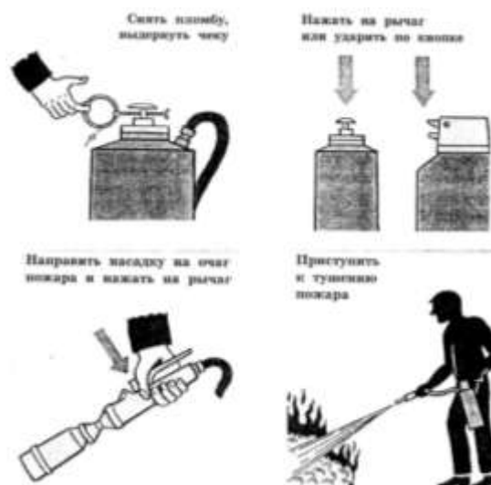
Рис.1. Приведение в действие воздушно-пенного огнетушителя.
