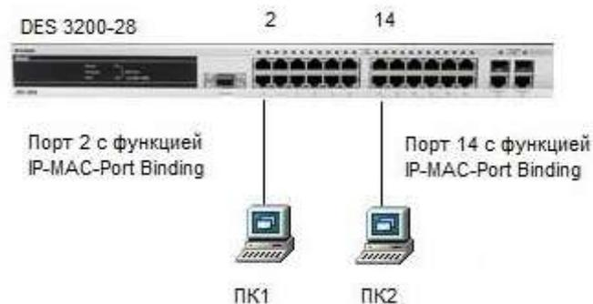
Рисунок 1 – Топология коммутируемой среды
