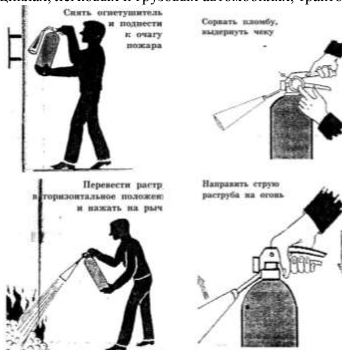
Рис. 3. Приведение в действие ручного углекислого огнетушителя.
