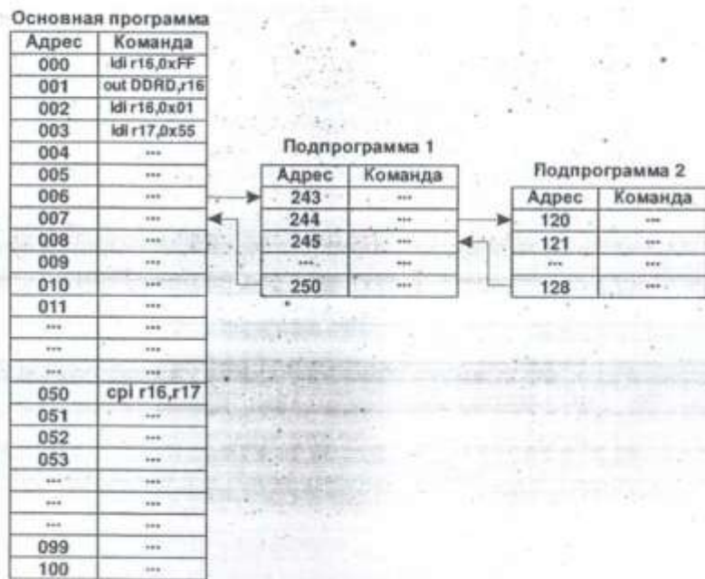
Рис. 2. Принцип заполнения стека
