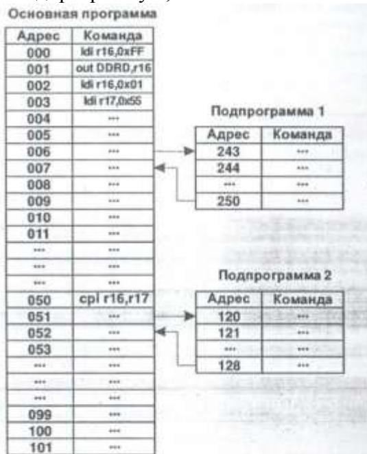
Рис. 1. Принцип работы указателя стека
