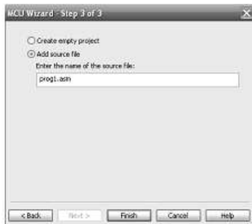
Рисунок 14 - Создание программного файла
