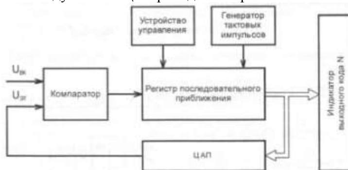
Рис. 30. Структурная схема одного канала АЦП последовательного приближения
