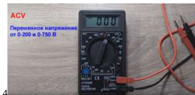
Рисунок 12 - Измерение переменного напряжения
