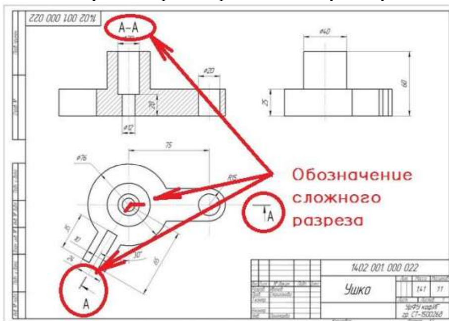
Рис 37 Обозначение сложного ломаного разреза на чертеже
