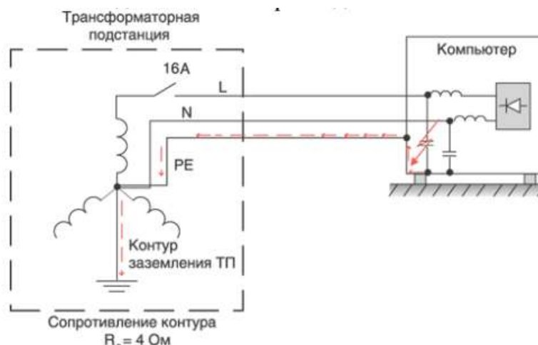
Рисунок 1 - Система заземления СВТ
