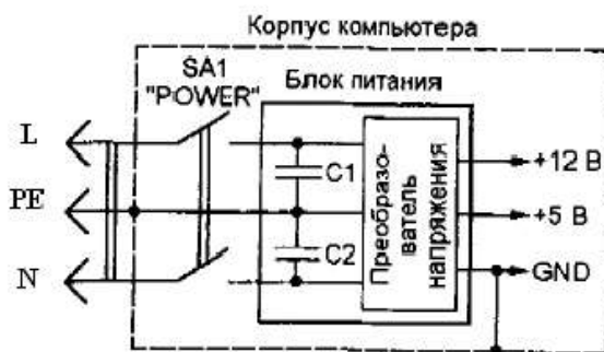
Рисунок 2 - Типовая схема подключения СВТ к питающей сети
