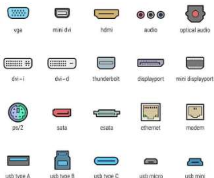
Рисунок 4 – Интерфейсы подключения периферийных устройств
